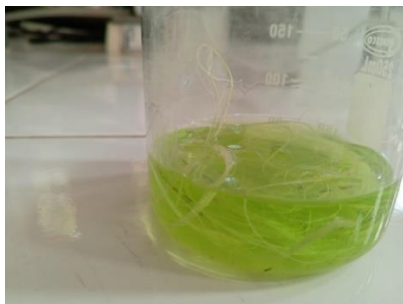
Ilustración 8. Fibra en agitador magnético por 30 minutos.
