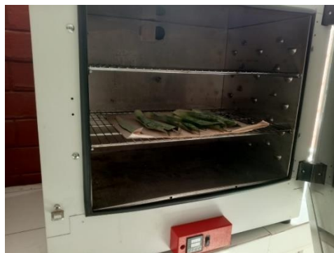
Ilustración 9. La fibra en la estufa por 48 horas a 45°C.
