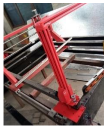
Figura 17. Estructura del puente de impresión 3D y corte láser
