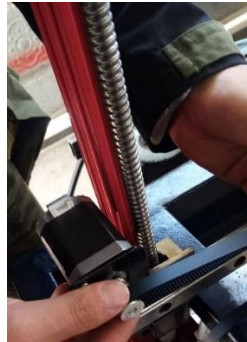
Figura 20. Implementación de correas síncronas para el eje Y
