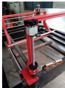
Figura 18. Implementación de los tornillos de bolas para el eje Z
