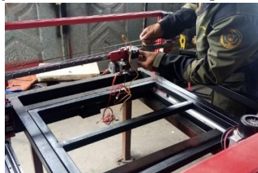
Figura 22. Montaje de los cabezales de impresión 3D y corte láser
